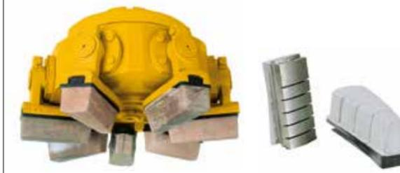
Testa per la lappatura/ levigatura/ lucidatura a sette braccetti oscillanti, ognuno con movimento indipendente. La sua architettura riduce vibrazioni e rotture in fase di lavoro.
